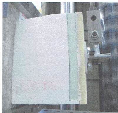
Bild 32: Styrofix EPS bei F_2 = 1'000 \text{ N} [Empa-Nr.: 5214007962/32]
