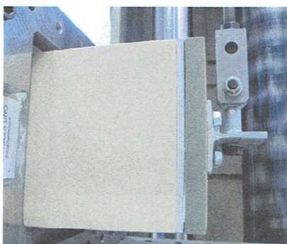
Bild 39: Herkules Uno bei F_{1,zul} = 5'000 \text{ N} [Empa-Nr.: 5214007962/39]
