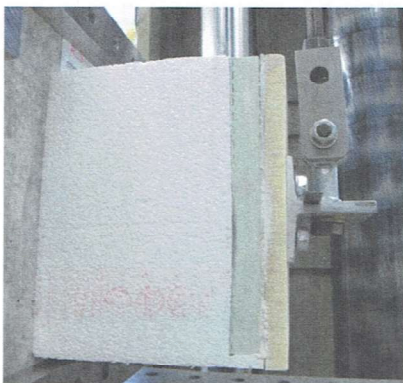
Bild 31: Styrofix EPS bei F_{1,zul} = 200 \text{ N} [Empa-Nr.: 5214007962/31]
